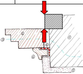
Das Bild zeigt den Querschnitt einer Gebäude - Außenwand mit einem Fenstereinbau dar. Dabei ist die schraffierte Fläche des Mauerwerks, die Fensterleibung. Die grüne Linie zeigt den Isothermen verlauf auf. Die Isotherme wird gesteuert mit der Entscheidung der Planung, wo das Fenster in der Leibung zu sitzen hat. Daher ist Fenstereinbau, eine Planungssache. Verweis zu Isothermen.
